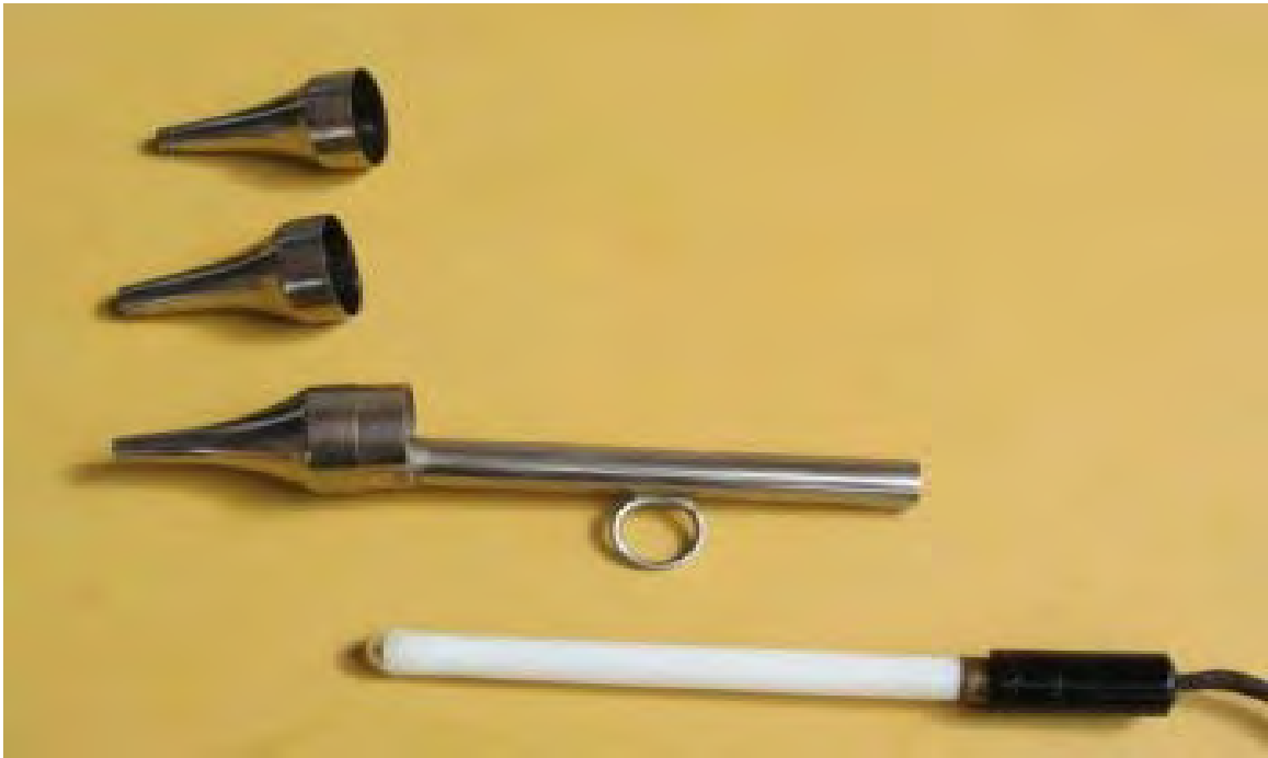
Figure 5 : speculums auriculaires et leur support, dans lequel s'insère la lampe tube. © Philippe Lépine.
