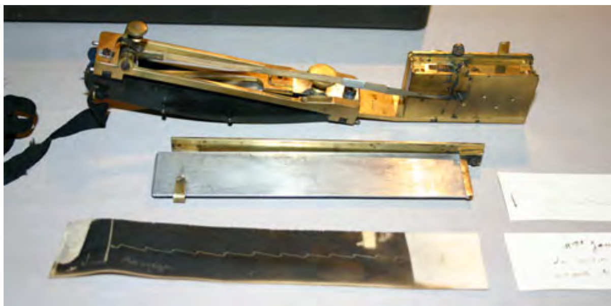
Figure 5 : Le sphygmographe sorti du coffret avec les divers éléments : en haut, l'ensemble avec le levier et le bloc porte-platine incluant le mécanisme d'horlogerie, au centre, la platine porte papier, en bas, les bandelettes de papier.
