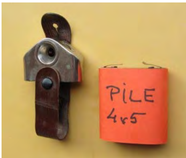
Figure 2 : La pile carrée de 4,5 V et son support en cuir (pour accrochage à la ceinture ?). © Philippe Lépine.
