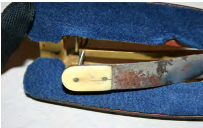
Figure 7 : La plaque d'ivoire servant à capter les oscillations du pouls au niveau de l'artère radiale. © Clystere.com
