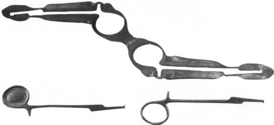
Figure 6 : En haut, empreinte découpée à l'emporte-pièce. En bas à gauche, ébauche d'instrument, à droite, après finition.
