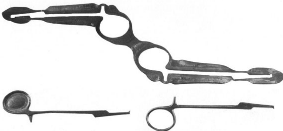
Figure 6 : En haut, empreinte découpée à l'emporte-pièce. En bas à gauche, ébauche d'instrument, à droite, après finition.
