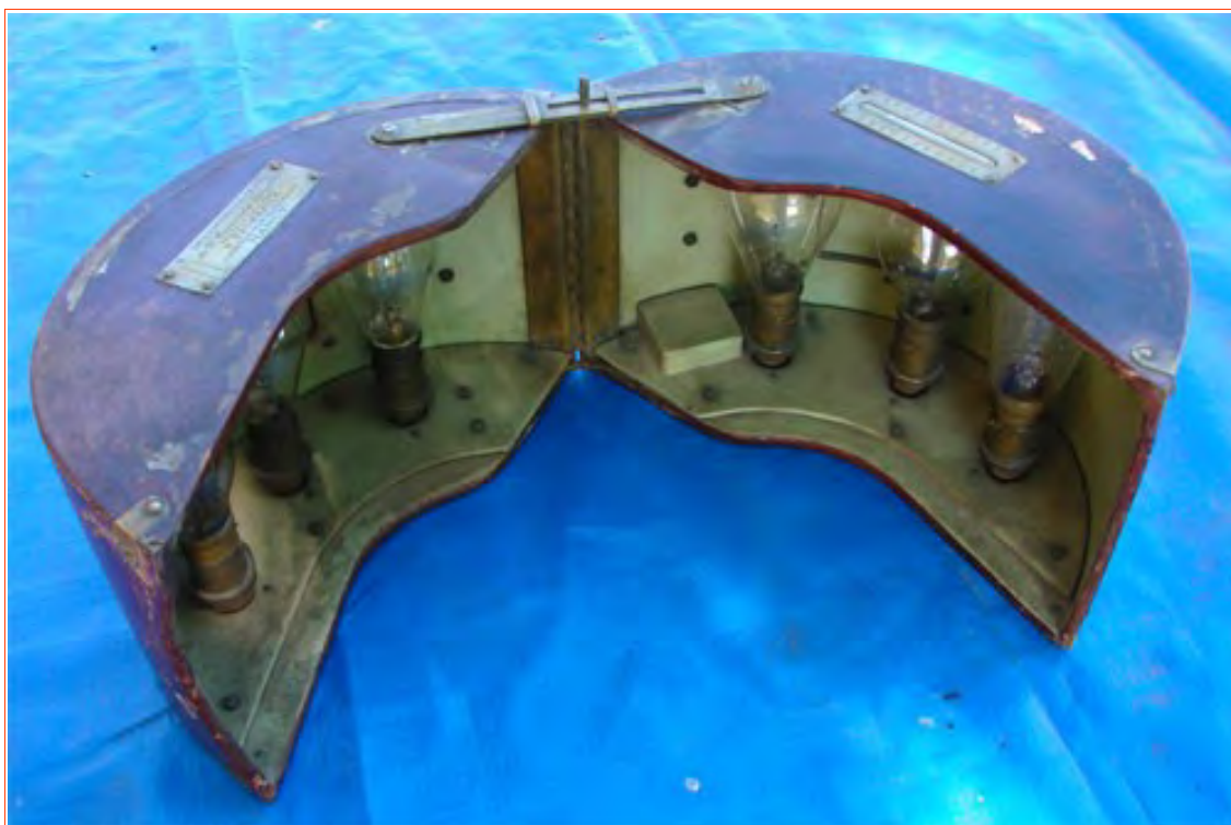
Figure 2 : Le radiateur en position ouverte, laissant voir les 6 lampes à incandescence.
